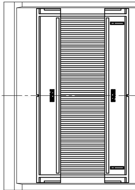
Adapterstück für board-to-board Abstand von 30mm (beidseitig verbaut mit Federleiste: 154809, Low Profile)
