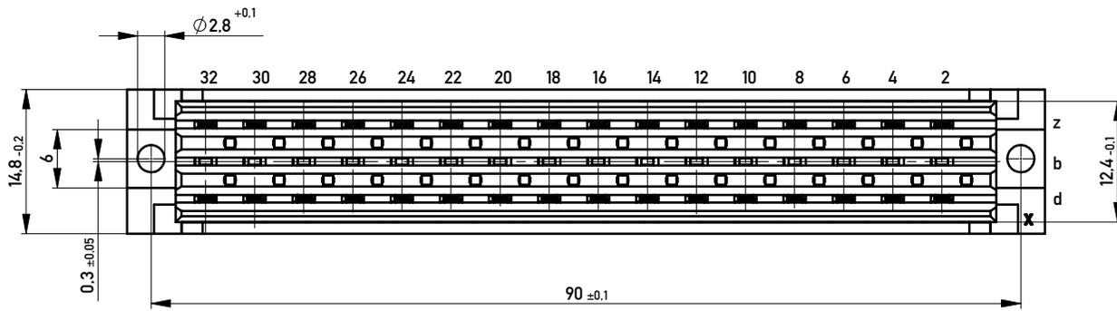
Lötanschluss 0,6 x 0,6 / solder terminal 0,6 x 0,6
