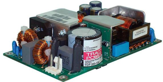
Das Hauptmerkmal der neuen TOP-200 Serie ist die höchste Leistungsdichte im Industriestandard 3.0" x 5.0" (76.2 x 127 mm). Das Netzgerät kann mit einer Ausgangsleistung von bis zu 200 W bei Konvektionskühlung in einem industriellen Arbeitstemperaturbereich von -25 °C bis +70 °C betrieben werden. Dieses Leistungsmerkmal wird durch modernste Technologie sowie einen extrem hohen Wirkungsgrad > 90 % erreicht, welcher den Einsatz eines zusätzlichen Lüfters überflüssig macht.
