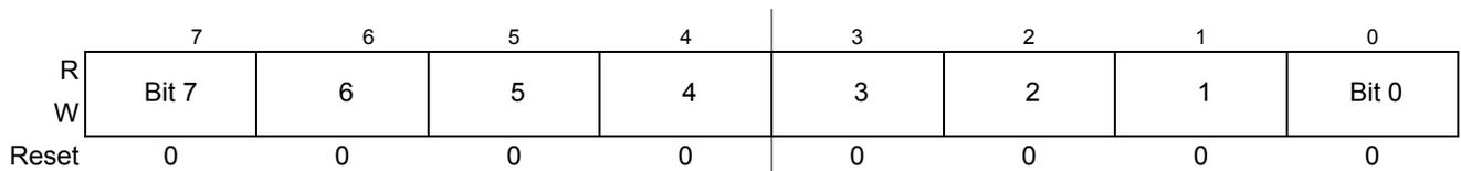
Figure 9-11. PWM Scale B Register (PWMSCLB)
