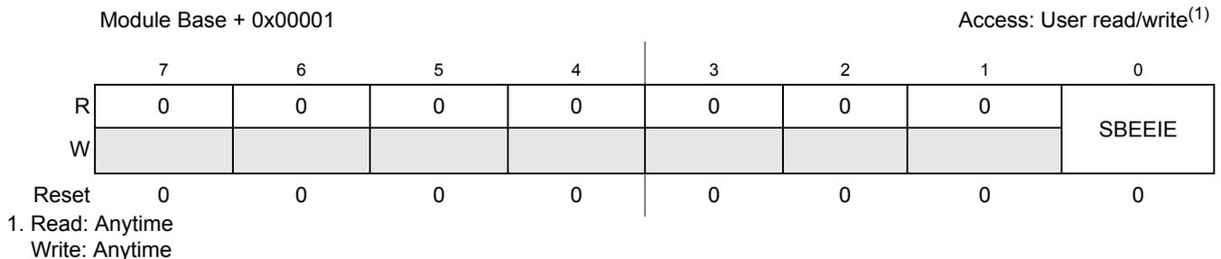
Figure 20-3. ECC Interrupt Enable Register (ECCIE)
