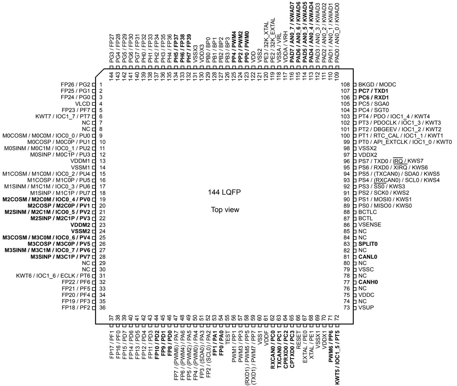
Figure 1-4. MC9S12ZVH-Family 144-pin LQFP pin out <sup>1 2</sup>
