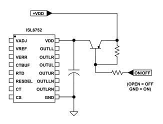
FIGURE 22. ON/OFF CONTROL USING VDD
