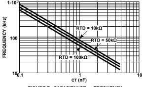
FIGURE 7. CAPACITANCE vs FREQUENCY
