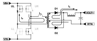
FIGURE 18. UPPER SWITCH TOGGLE AND RESONANT TRANSITION
