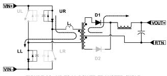
FIGURE 16. UR TO LL POWER TRANSFER CYCLE
