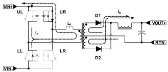
FIGURE 15. UPPER SWITCH TOGGLE AND RESONANT TRANSITION
