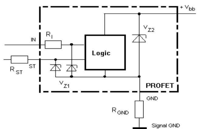
$V_{Z1}=6.1\text{V typ.}$ ,  $V_{Z2}=V_{bb(AZ)}=47\text{V typ.}$
