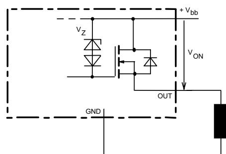
$V_{ON}$  clamped to 47V typ.
