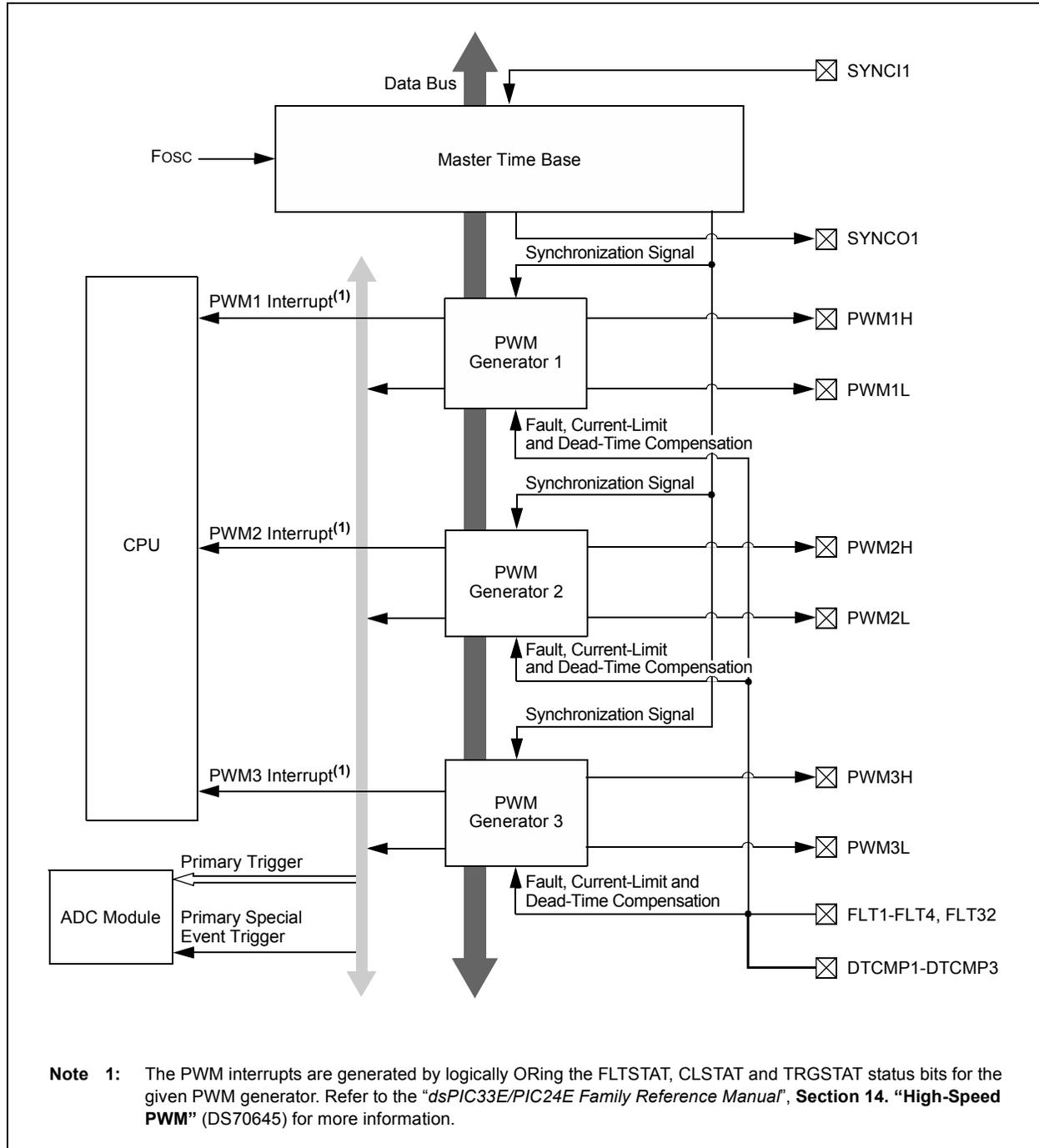
FIGURE 16-2: HIGH-SPEED PWMx MODULE REGISTER INTERCONNECTION DIAGRAM
