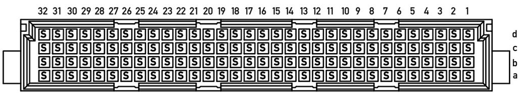
Lötanschluss 0,6x0,6mm / solder terminal 0,6x0,6mm
