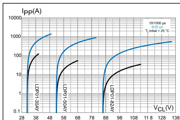
**Figure 14. ISO 16750-2 test B response**
