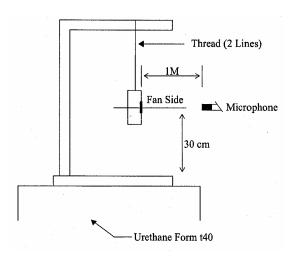
1 METER FROM MICROPHONE TO FAN INTAKE
