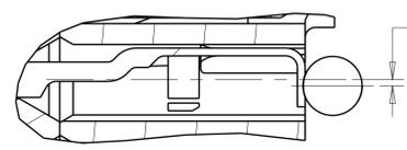
0.08 OFFSET FROM CONTACT C/L TO SOLDER BALL C/L
