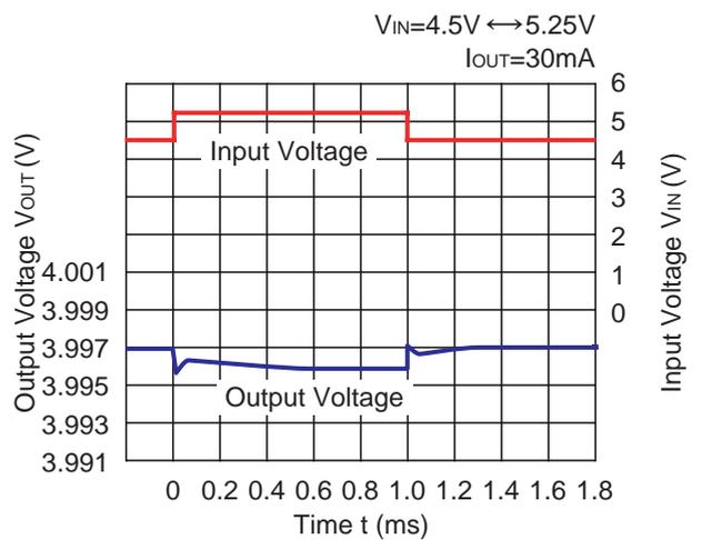
**12) Load Transient Response ( $C1=1.0\mu F$ ,  $C2=1.0\mu F$ ,  $t_r=t_f=5\mu s$ ,  $T_{opt}=25^\circ C$ )**
