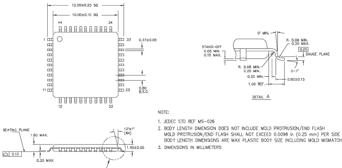
Figure 4-7. 44-Lead TQFP
