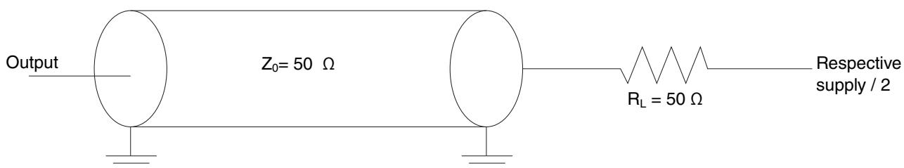
**Figure 45. I<sup>2</sup>C AC test load**
