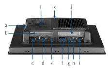
a. CFast b. PCI-E Slot
