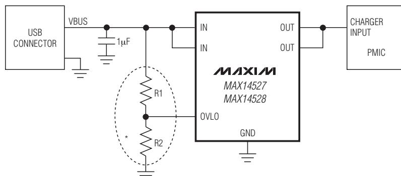
\*R1 AND R2 ARE REQUIRED ONLY FOR ADJUSTABLE OVLO; OTHERWISE, CONNECT OVLO TO GND.
