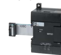
■ CompoBus/S I/O Link Unit CP1W-SRT21
