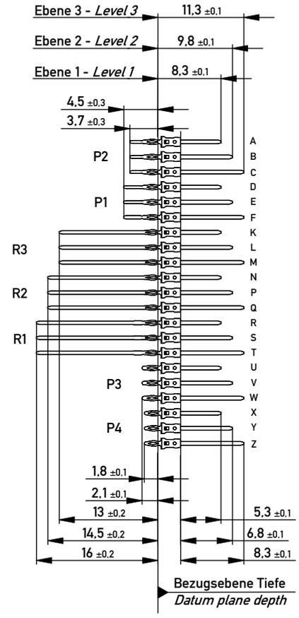
Lochbild für Leiterplatte (Bestückungsseite) Board hole pattern (Component mounting side)
