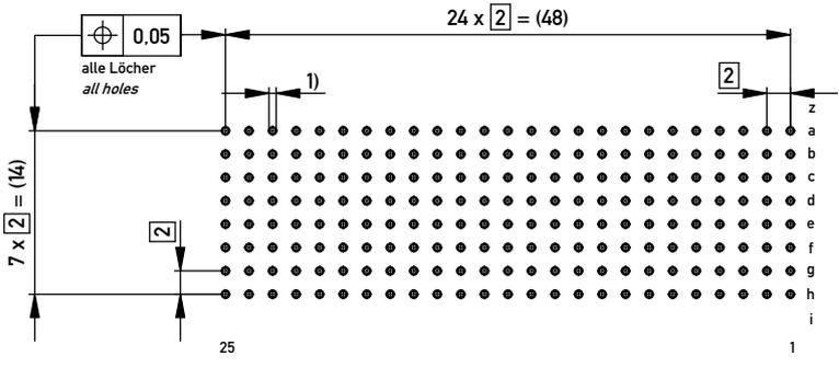
1)  $\varnothing 0,6 \pm 0,05$  Durchmesser des metallisierten Loches
