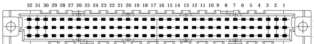
Leiterplatten-Lochbild / PCB drillhole pattern
