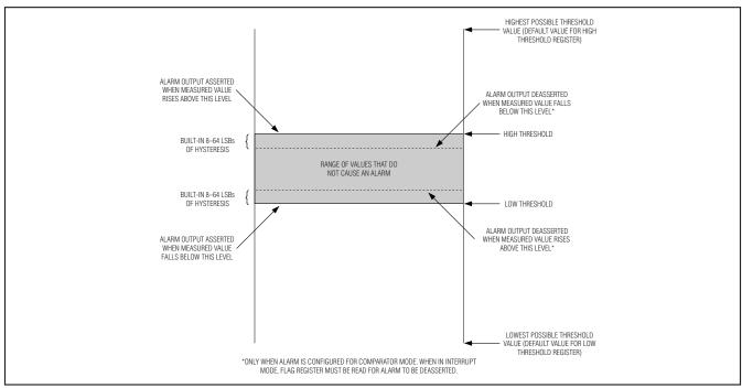
Figure 20. Window-Mode Alarm-Threshold Diagram
