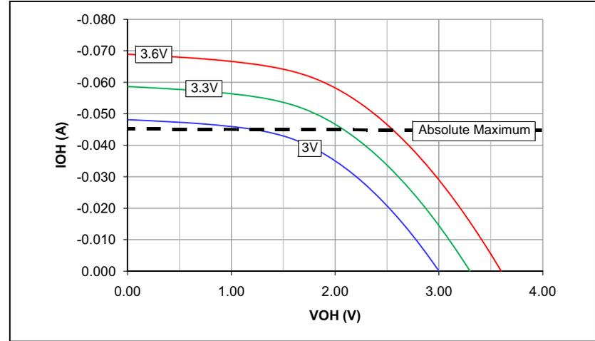
**FIGURE 27-2:  $V_{OH}$  – 8x DRIVER PINS**
