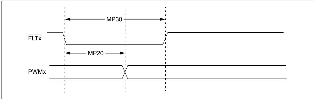
**FIGURE 24-10: HIGH-SPEED PWMx MODULE TIMING CHARACTERISTICS**
