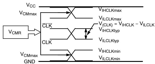
**Figure 13.  $V_{CM}$  Diagram**
