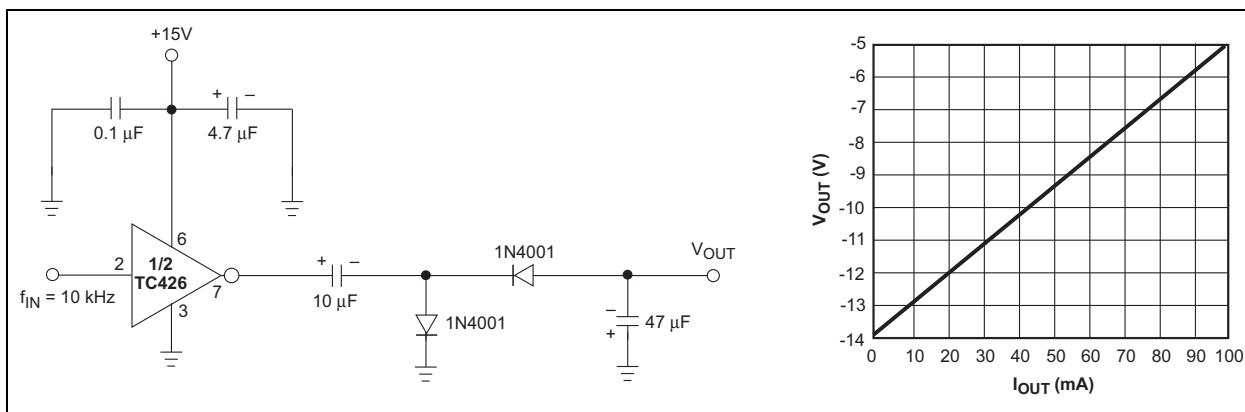
**FIGURE 3-4:** Voltage Inverter
