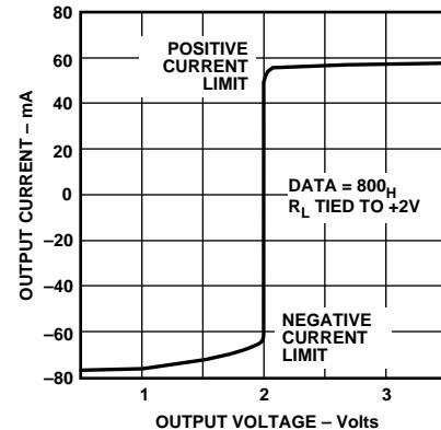
Figure 7.  $I_{\text{OUT}}$  vs.  $V_{\text{OUT}}$
