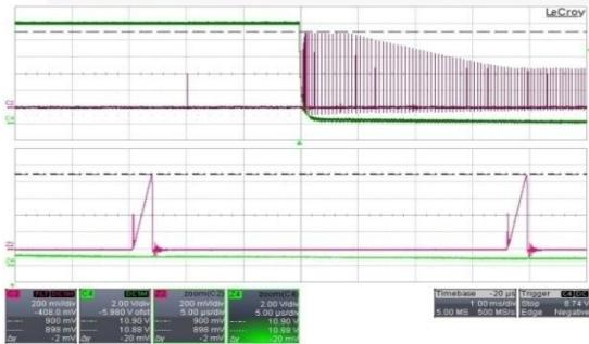
**Figure 29.**  $C2[V_{cs}]$ ,  $C4[Vo]$ , 264 V<sub>AC</sub>/50 Hz,  $I_o=0$  A,
