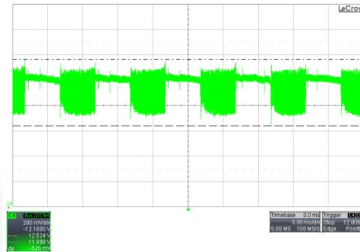
Figure 22. C4[V<sub>o</sub>], 264 V<sub>AC</sub> / 50 Hz, V<sub>o</sub>=12 V
