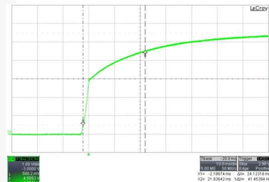
Figure 14. C4[Vo], 90 V<sub>AC</sub>/60 Hz, Full Load
