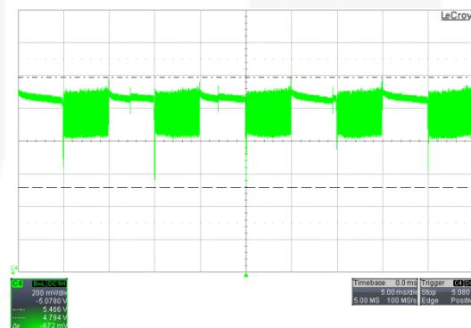
Figure 18.  $C4[V_o]$ , 264 V<sub>AC</sub> / 50 Hz,  $V_o=5 \text{ V}$
