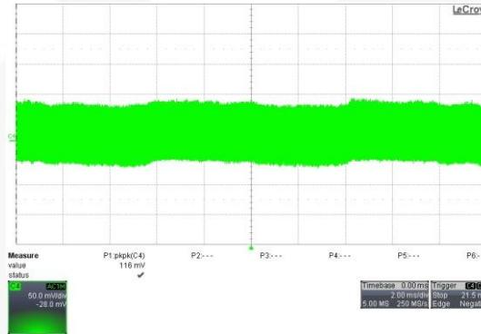
**Figure 27.**  $C4[Vo]$ , 90 V<sub>AC</sub> / 60 Hz,  $I_o=1.67$  A,
