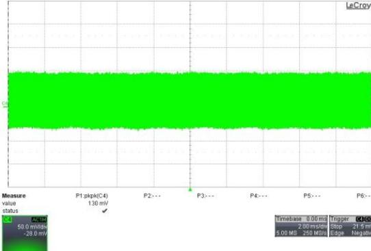
**Figure 26.**  $C4[Vo]$ , 264 V<sub>AC</sub> / 50 Hz,  $I_o=1.8$  A,
