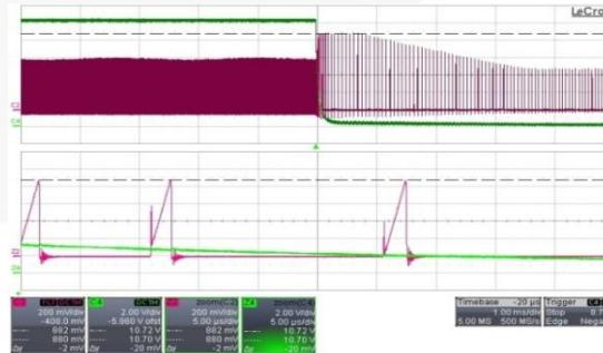
**Figure 30.**  $C2[V_{cs}]$ ,  $C4[Vo]$ , 264 V<sub>AC</sub>/50 Hz,
