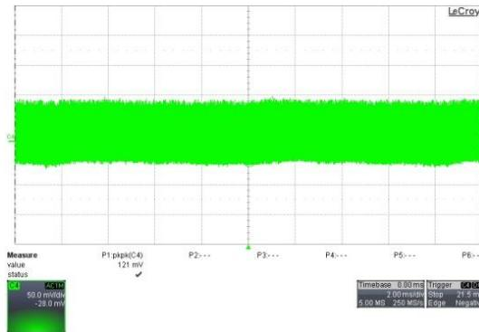
**Figure 25.**  $C4[Vo]$ , 90 V<sub>AC</sub> / 60 Hz,  $I_o=1.8$  A,
