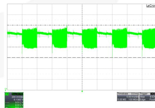
Figure 20.  $C4[V_o]$ , 264 V<sub>AC</sub> / 50 Hz,  $V_o=9 \text{ V}$
