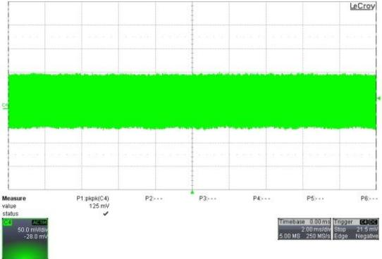
**Figure 28.**  $C4[Vo]$ , 264 V<sub>AC</sub> / 50 Hz,  $I_o=1.67$  A,
