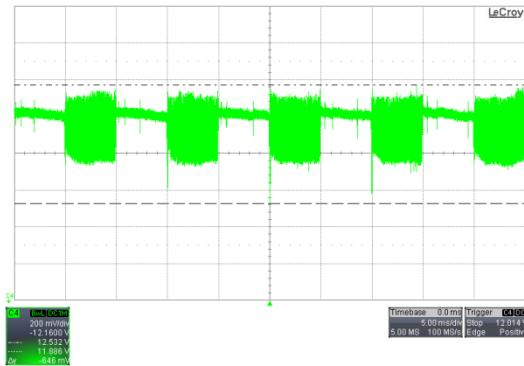
Figure 21. C4[V<sub>o</sub>] 90 V<sub>AC</sub> / 60 Hz, V<sub>o</sub>=12 V
