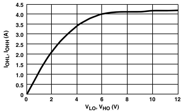
FIGURE 20. PEAK PULL-DOWN CURRENT vs OUTPUT VOLTAGE
