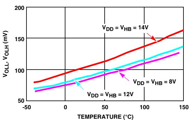
FIGURE 12. LOW LEVEL OUTPUT VOLTAGE vs TEMPERATURE
