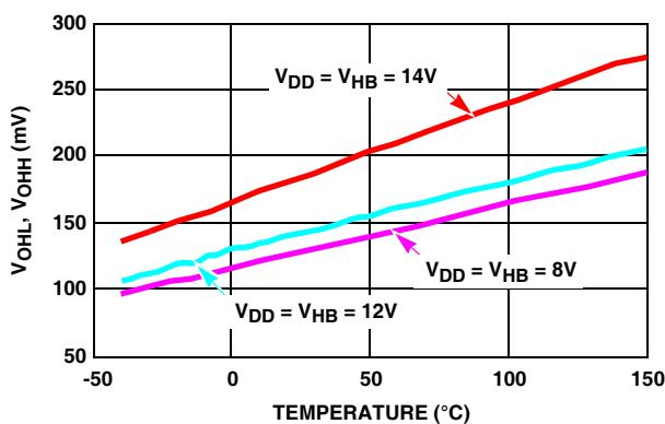
FIGURE 11. HIGH LEVEL OUTPUT VOLTAGE vs TEMPERATURE
