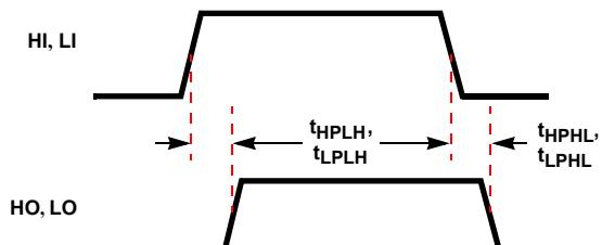
FIGURE 5. PROPAGATION DELAYS
