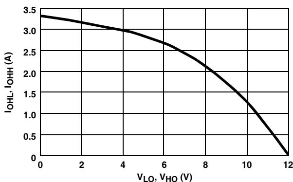
FIGURE 19. PEAK PULL-UP CURRENT vs OUTPUT VOLTAGE
