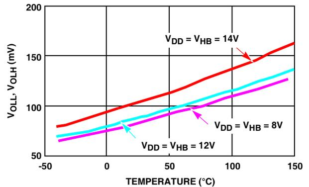
FIGURE 12. LOW LEVEL OUTPUT VOLTAGE vs TEMPERATURE
