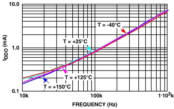
FIGURE 7. ISL2110  $I_{DD}$  OPERATING CURRENT vs FREQUENCY
