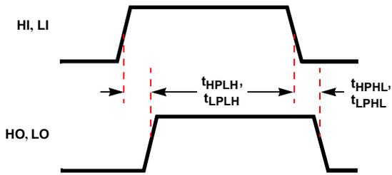
FIGURE 5. PROPAGATION DELAYS
