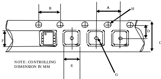
**CARRIER TAPE DIMENSION FOR 8SOICN**
