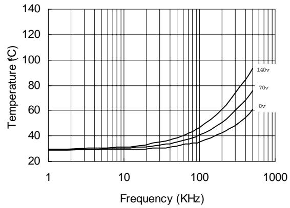
Figure 24. IR2183 vs. Frequency (IRFBC40),
