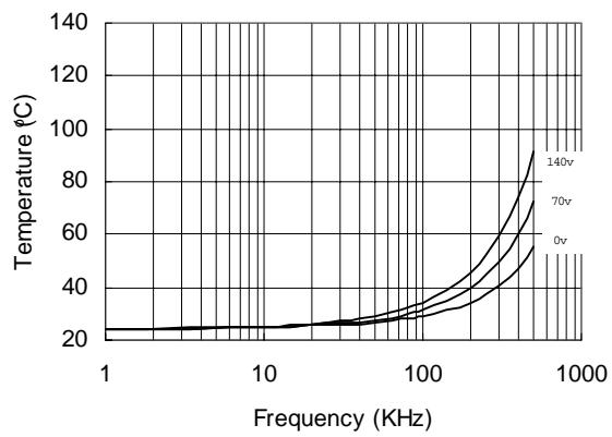
Figure 28. IR21834 vs. Frequency (IRFBC40),
