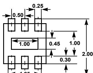
**LAND PATTERN 6****L6.1.6x1.6A****6 LEAD ULTRA THIN DUAL FLAT NO-LEAD PLASTIC PACKAGE**
