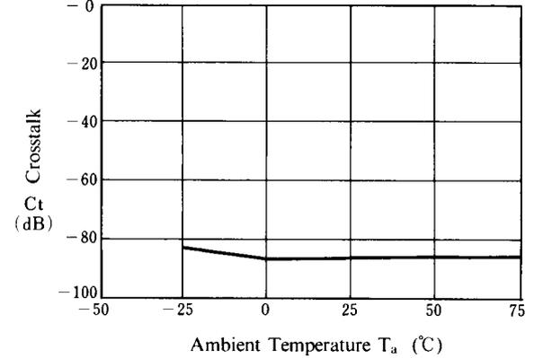
■ TYPICAL CHARACTERISTICS (T<sub>a</sub> = +25°C)
