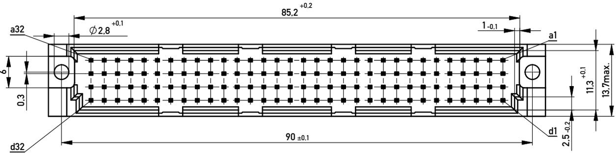
Gerader Anschluss 0,6x0,6mm / straight terminal 0,6x0,6mm
