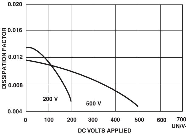
**NON-MAGNETIC X7R DIELECTRIC - TYPICAL PARAMETERS**
