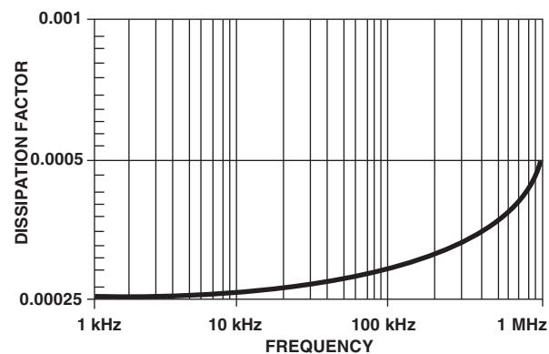
**NON-MAGNETIC X7R DIELECTRIC - TYPICAL PARAMETERS**
