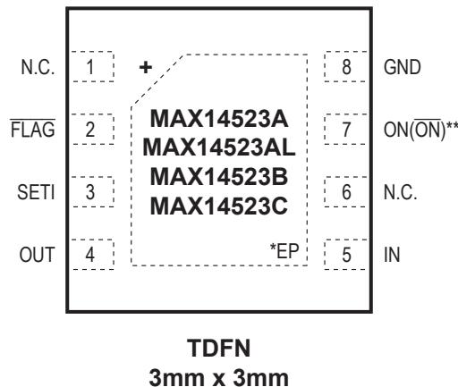
\*CONNECT EXPOSED PAD TO GND.
