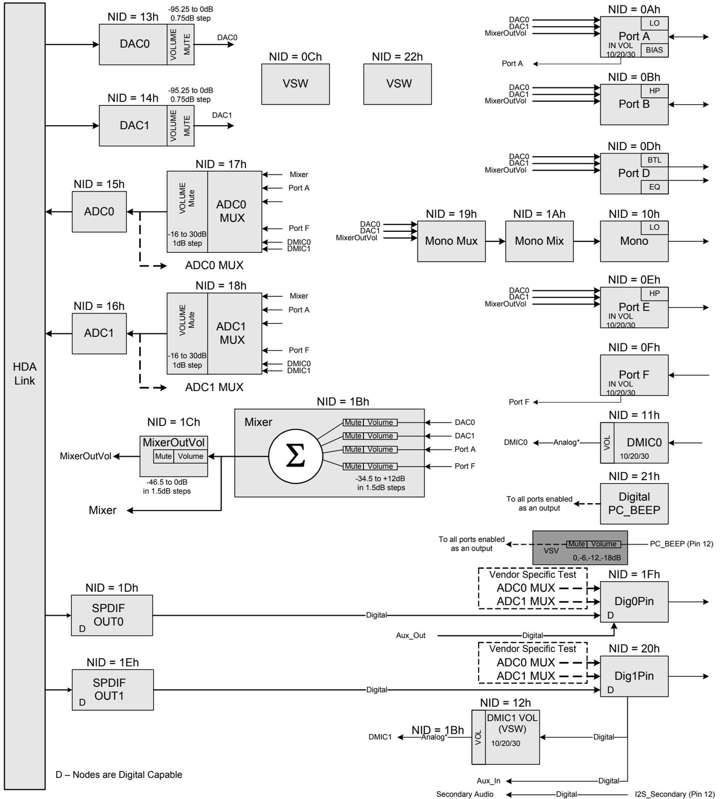
Figure 23. Widget Diagram
