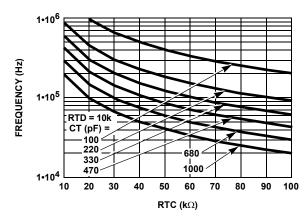
FIGURE 4. CAPACITANCE vs FREQUENCY
