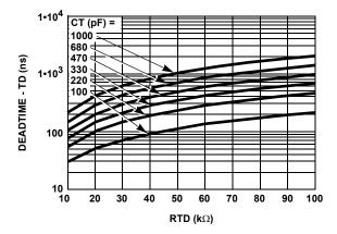
FIGURE 3. DEADTIME (DT) vs CAPACITANCE
