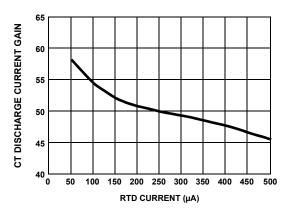
FIGURE 2. OSCILLATOR CT DISCHARGE CURRENT GAIN
