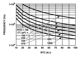
FIGURE 4. CAPACITANCE vs FREQUENCY
