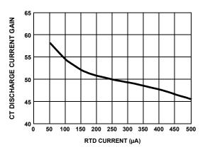
FIGURE 2. OSCILLATOR CT DISCHARGE CURRENT GAIN
