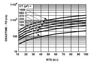
FIGURE 3. DEADTIME (DT) vs CAPACITANCE
