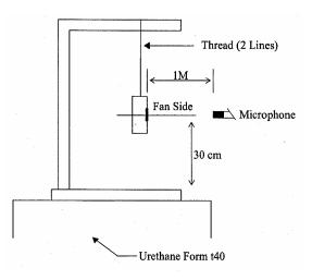
1 METER FROM MICROPHONE TO FAN INTAKE
