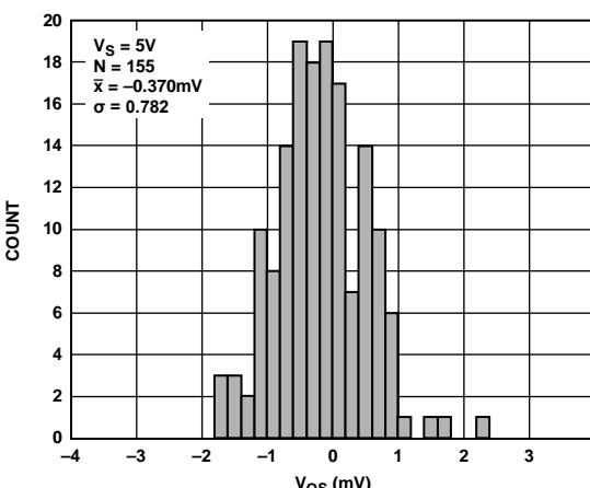
Figure 36.  $V_{OS}$  Distribution
