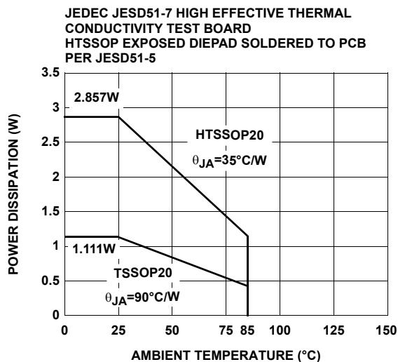
FIGURE 19. PACKAGE POWER DISSIPATION vs AMBIENT TEMPERATURE
