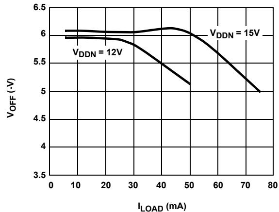
FIGURE 12. V<sub>OFF</sub> vs I<sub>OFF</sub>
