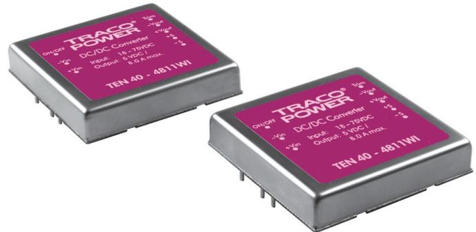
Die TEN 40WI Serie bietet sehr leistungsfähige 40 W DC/DC-Konverter mit einem sehr weiten 4:1 Eingangsbereich in einem ultrakompakten Gehäuse mit Industriestandard Pin-Out. Der sehr hohe Wirkungsgrad ermöglicht einen Arbeitstemperaturbereich von  $-40^{\circ}\text{C}$  bis  $85^{\circ}\text{C}$ . Weitere Merkmale sind die externe Ein/Aus-Funktion, die einstellbare Ausgangsspannung, Überspannungsschutz sowie die Dauerkurzschlussfestigkeit.
