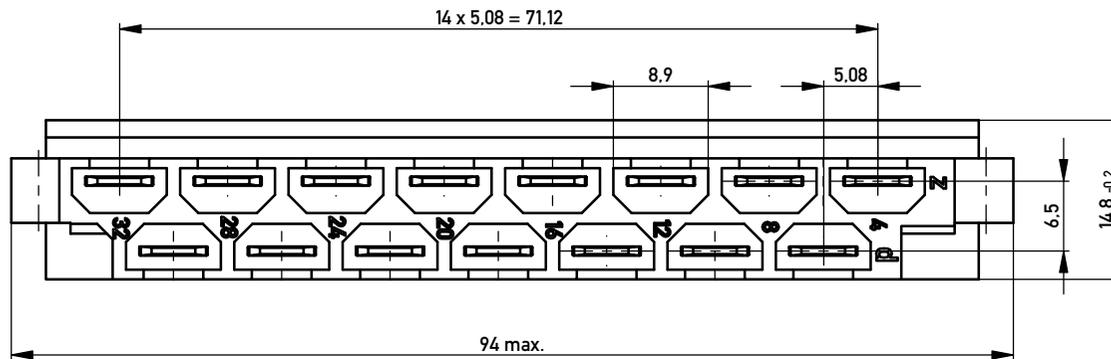
Flachstecker 6,3 x 0,8 mm / blade terminal 6,3 x 0,8 mm
