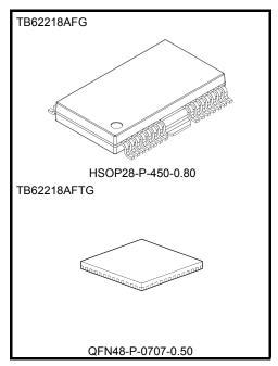
Weight HSOP28-P-0450-0.80: 0.79 g (typ.) QFN48-P-0707-0.50: 0.14 g (typ.)
