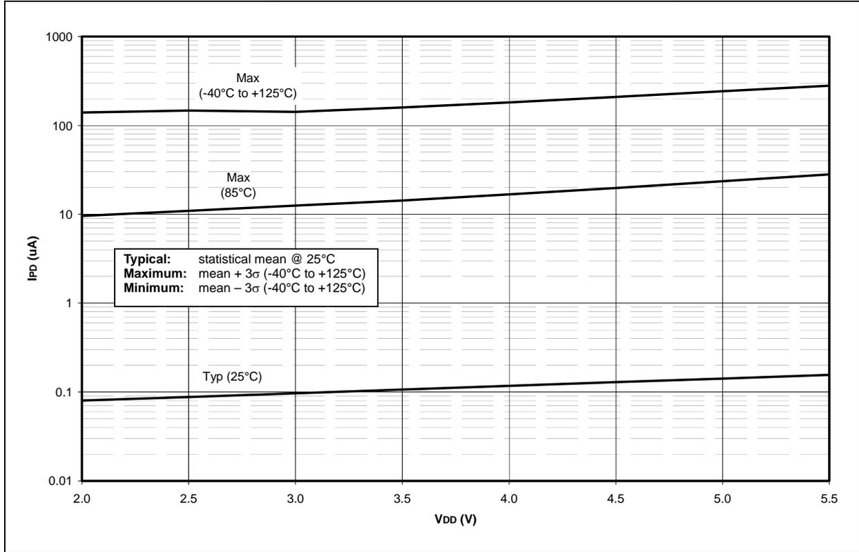
**FIGURE 28-16: TYPICAL AND MAXIMUM ΔI<sub>BOR</sub> vs. V<sub>DD</sub> OVER TEMPERATURE, V<sub>BOR</sub> = 2.00-2.16V**
