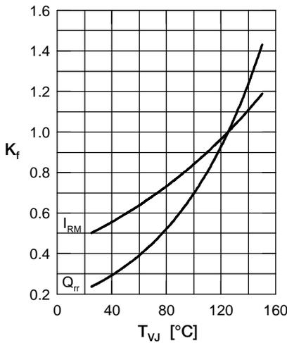
Fig. 4 Typ. dynamic parameters  $Q_{rr}$ ,  $I_{RM}$  versus  $T_{VJ}$
