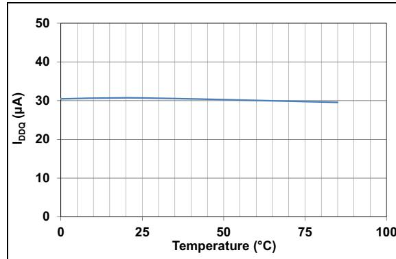
**FIGURE 2-4:**  $I_{DDQ}$  vs. Temperature.
