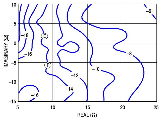
Figure 24. P3dB Load Pull AM/PM Contours (°)
