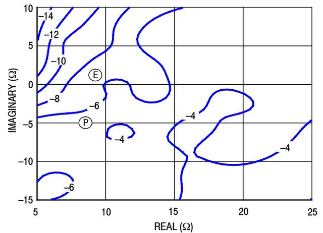
Figure 20. P1dB Load Pull AM/PM Contours (°)
