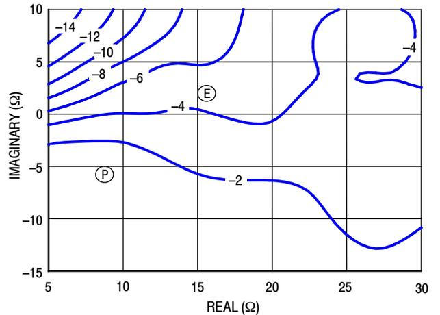
Figure 12. P1dB Load Pull AM/PM Contours (°)
