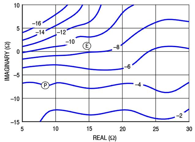
Figure 16. P3dB Load Pull AM/PM Contours (°)
