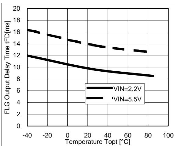
17) Flag Output Delay Time vs. V<sub>IN</sub> Input Voltage
