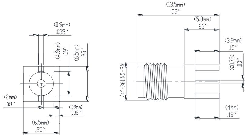
Model 72970 SMA STRAIGHT JACK PCB RECEPTACLE
