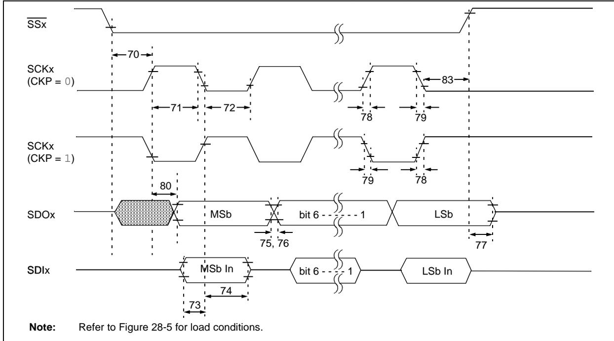
**TABLE 28-18: EXAMPLE SPI MODE REQUIREMENTS (SLAVE MODE TIMING, CKE = 0)**
