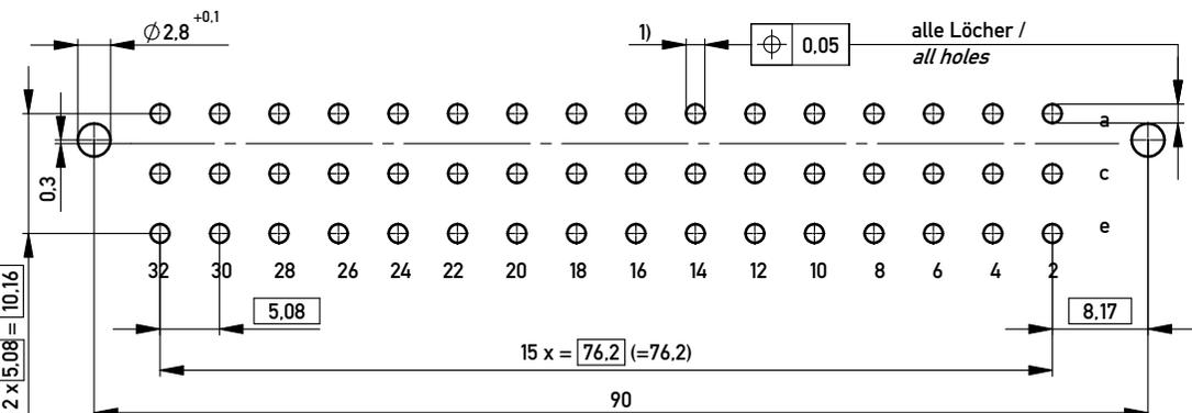
Elastische Einpresszone / compliant pressfit zone
